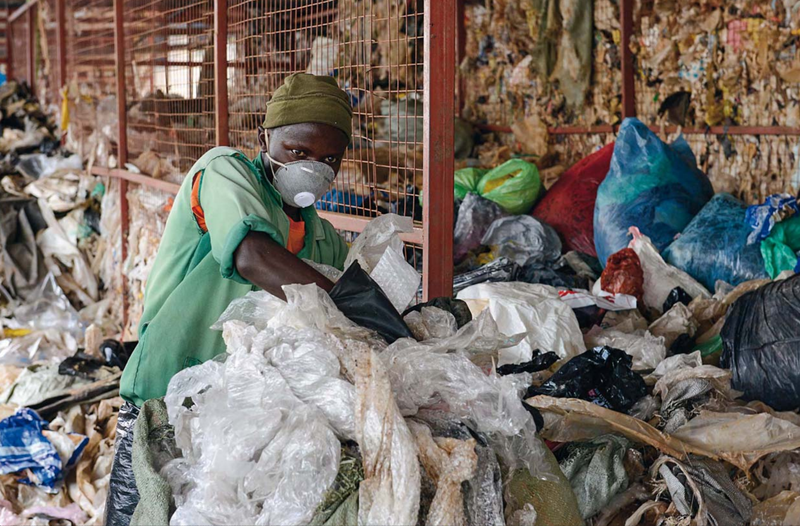
Tonnenweise Müll: Lastwägen liefern den Abfall an, dann wird er nach Plastikarten und Verschmutzungsgrad sortiert.
