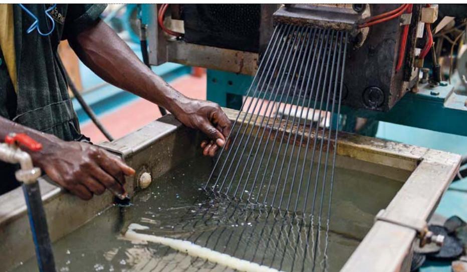
Geschreddertes Plastik wird zu Plastikschnüren verarbeitet.
